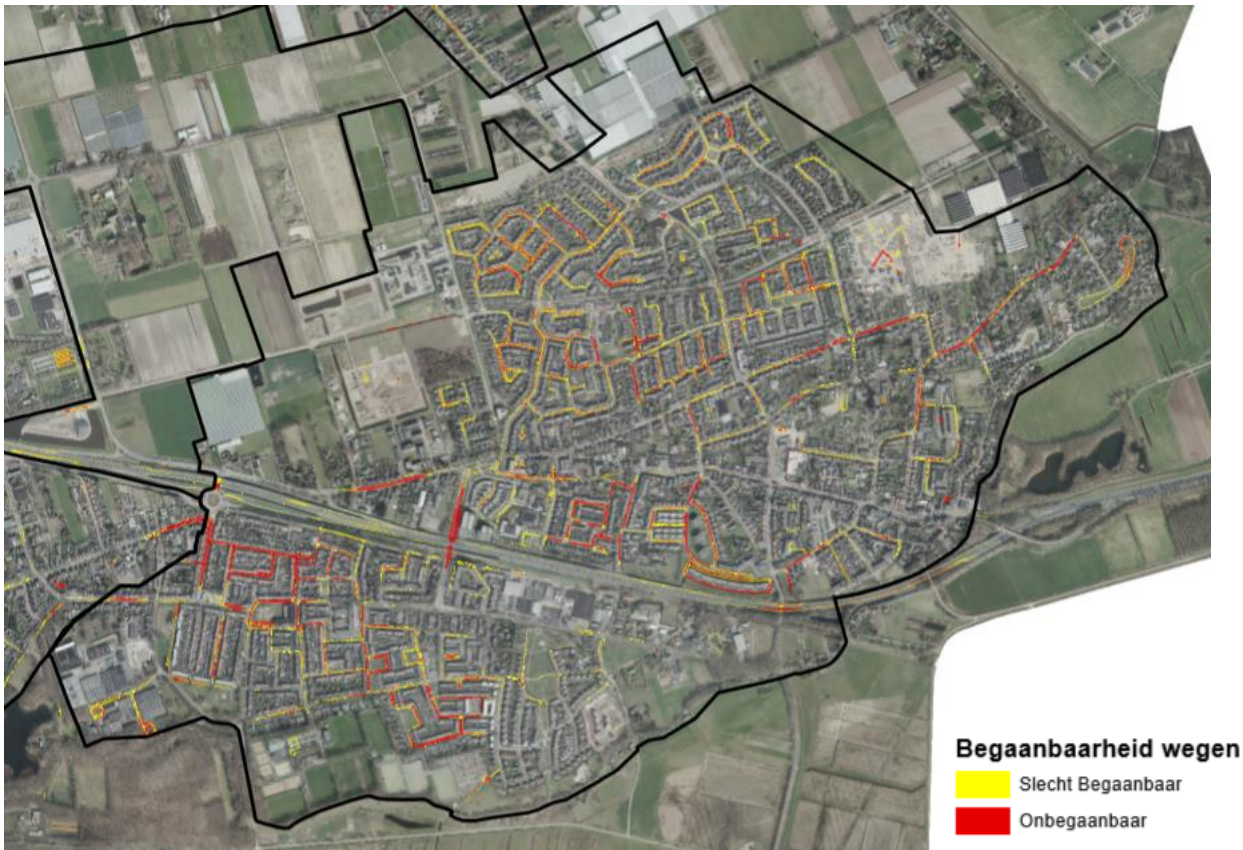
Figuur 6 Begaanbaarheid wegen als gevolg van wateroverlast bij een 70 mm bui in de kern Vlijmen.
