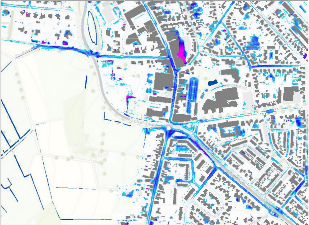
Figuur 3: Voorbeeld van een resultaat uit een hydraulische simulatie van water op straat in Woensdrecht/Hoogerheide (70 mm in één uur)
