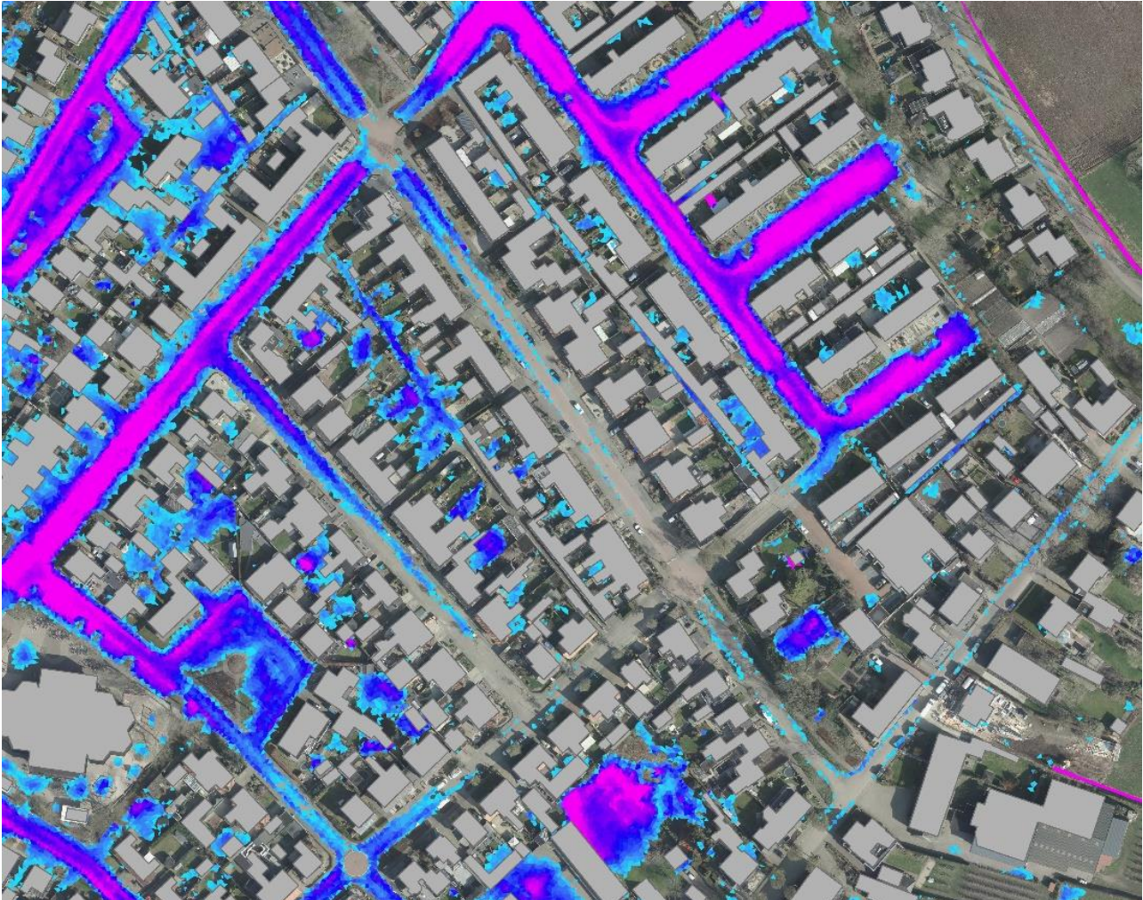
Figuur 2. Voorbeeld van een resultaat uit een hydraulische simulatie van water op straat.
